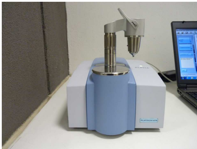
Fig. 27 Espectrômetro Infravermelho com módulo ATR. Bruker Alpha Platinum.
